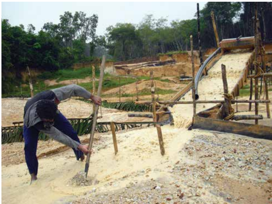
Imagem 6. Desmonte hidráulico. Por Natalia Guerrero, nov. 2011.
